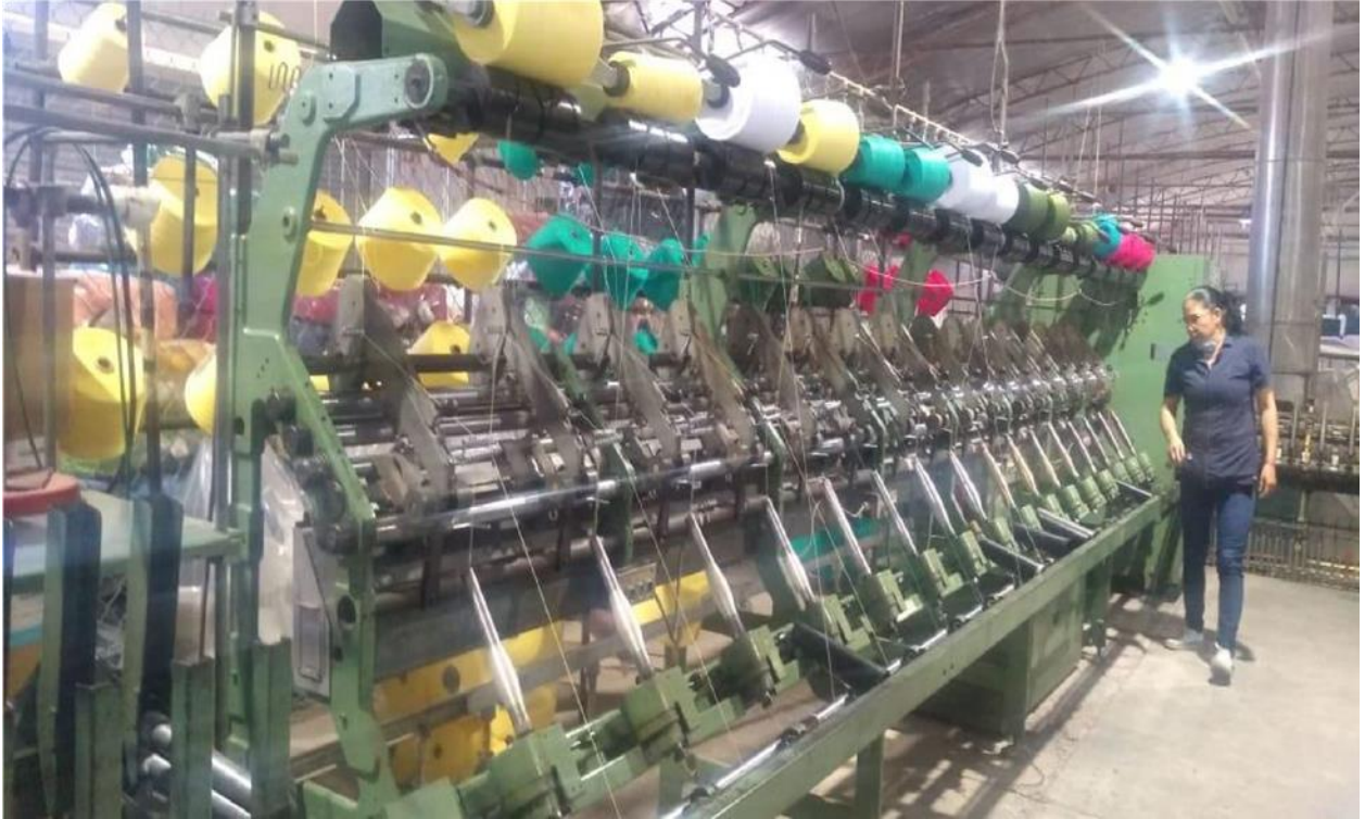
Ilustración 6 Torzal metálico en funcionamiento
